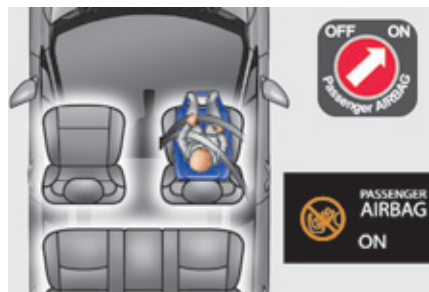
Beifahrersitz in höchster Position und mittlerer Längseinstellung.
