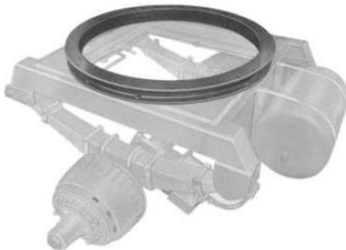
Bild 9 Drehgestell (grau) mit Lenkkranz
